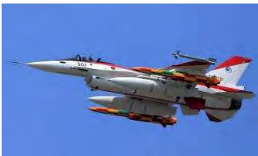
開発実験でF2戦闘機に搭載された空対艦ミサイル「ASM3」(両翼下のしま模様のミサイル) = 2015年4~5月ごろ撮影 (防衛装備庁提供)
