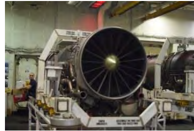
空母艦尾側の格納庫で修理される艦載機のエンジン
