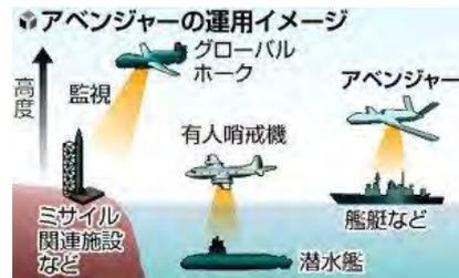
アベンジャーはジェットエンジンを搭載し、最高時速は740キロ・メートル。1回の離陸で18時間以上飛行できる。対艦ミサイルや投下型爆弾も搭載可能とされ、有事の際、人員を危険にさらすことなく敵の艦艇などに反撃できる。実現すれば、自衛隊として初めて本格的な無人攻撃機を導入することになる。
