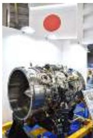
戦闘機用の国産エンジン「XF9」の試験用エンジンファン
