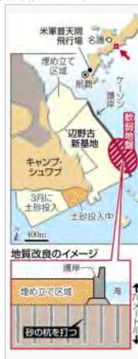
沖縄県名護市辺野古（へのこ）の米軍新基地建設を巡り、防衛省沖縄防衛局が、軟弱地盤の広がる埋め立て海域に、約六万本の杭（くい）を海面から深さ七十メートルまで打って地盤を強化する工法を検討していることが分かった。当初の計画では軟弱地盤を想定しておらず、大規模な追加工事となることは必至だ。専門家は「過去に例がないほどの深さの地盤改良で難しい工事。膨大な費用と時間がかかるだろう」と指摘する。（中沢誠）
