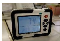
報道部に設置した空気質測定器。画面の上段にCO2濃度、下段左に温度、下段右に湿度を表示する。パソコン
