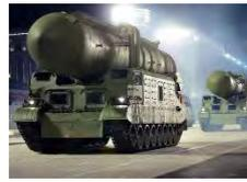
準中距離弾道ミサイル「北極星2号」を搭載する装軌式(いわゆるキャタピラ式)のTEL。北朝鮮にとっては大型装軌式TELよりも扱いやすいといわれる(画像：朝鮮中央放送)。
